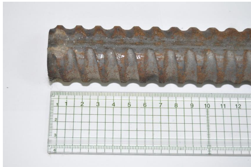
螺紋節鋼筋（符合規定）
