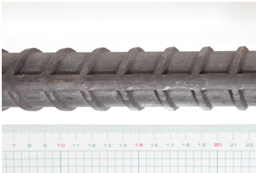
竹節鋼筋（不符合規定）
